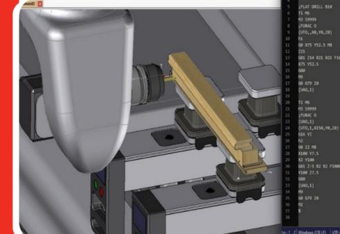
MAQUINAÇÃO CONFIGURADA ATÉ 5 EIXOS CONTÍNUOS
